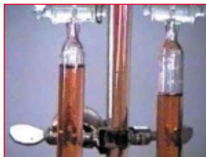
Fig. 1 - Electrólise da água.
